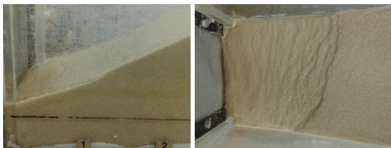
Figure 8. Vue de face et de dessus de l'écoulement d'eau à la surface de glissement pour une charge hydraulique de 26 cm
